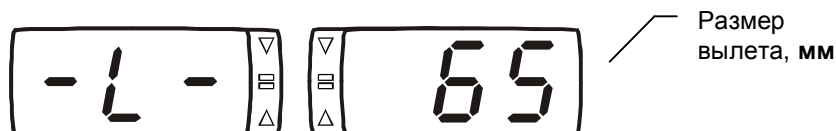
Рисунок 2.29 – Показания индикаторов во время пользования электронной линейкой для измерения вылета (измеритель диаметра выключен)
